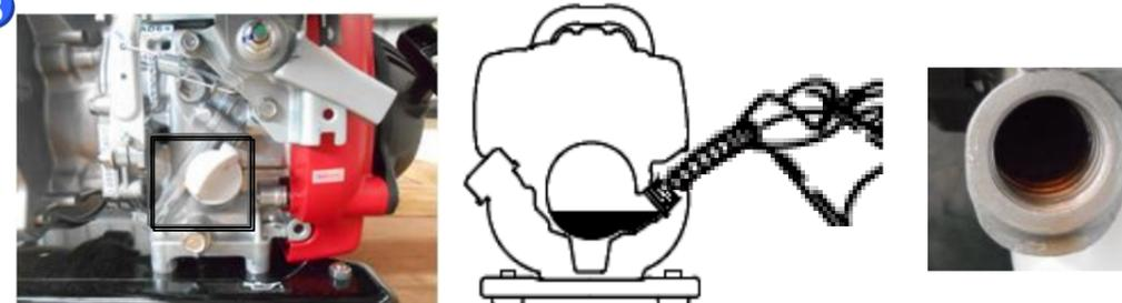
Antes de retirar la etiqueta de advertencia en color amarillo. Coloque aceite al motor hasta la parte superior de la boquilla como se muestra en la imagen. Comience con 250 ml.
