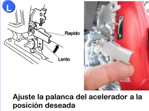
Ajuste la palanca del acelerador a la posición deseada
