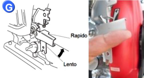
Mueva la palanca del acelerador hacia la izquierda a la mitad del recorrido
